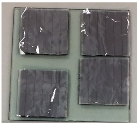
Рисунок 2. Укладка разделительной ткани Р-Текс Р85ПА и неперфорированной разделительной плёнки «Фтороплан».
