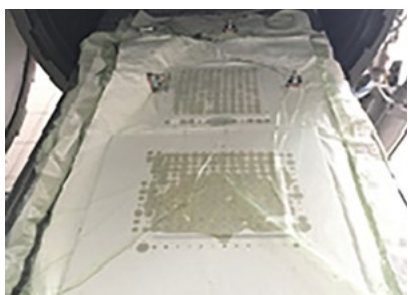
Рисунок 5. Технологические пакеты после формовки в автоклаве.
