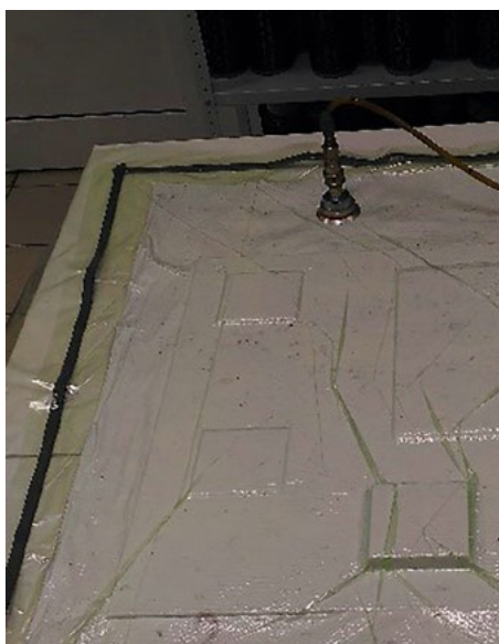
Рисунок 4. Технологические пакеты, собранные с применением материалов производства ООО «Композит-Изделия».
