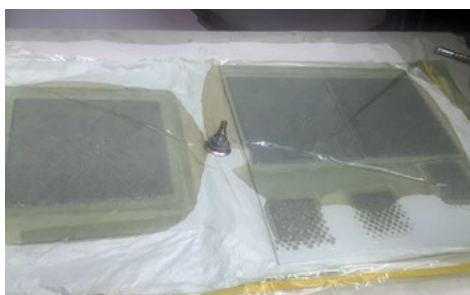
Рисунок 5. Технологические пакеты после формовки в автоклаве.
