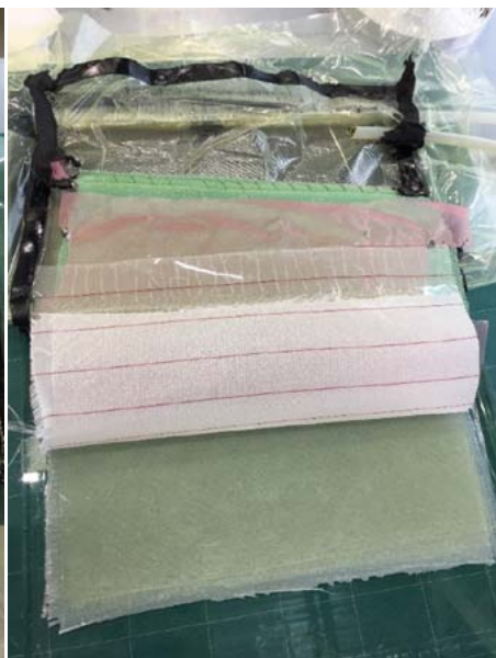
Рисунок 4. Удаление вспомогательных и расходных материалов с ламината и оснастки.
